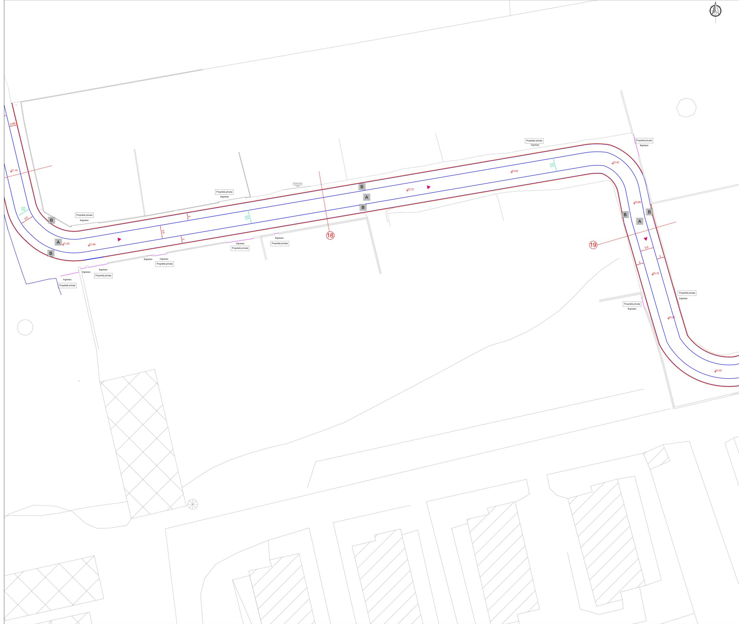
NB: La carreggiata stradale vera' delimitata mediante strisce longitudinali eseguite mediante applicazione di vernice rifrangente premiscelata di colore bianco o gialla permanente, in quantità di 1,6 kg/m². L'intera area sarà, prima dell'inizio delle lavorazioni, inoltre, ripulita dalla vegetazione infestante presente.
